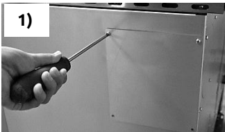
1) odvijačem skinite vanjski zaštitni poklopac
