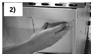
2) skinite lim ispod poklopca pritiskom na najslabiji spoj
